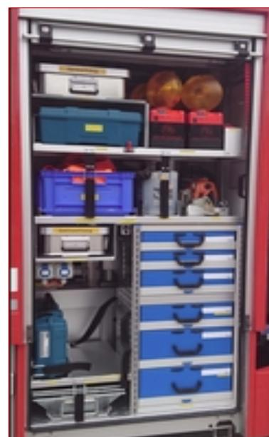
In den beiden Rollläden im Fahrzeugaufbau ist auf der linken Fahrzeugseite das benötigte Equipment für den Brandeinsatz (u. a. Atemschutz, Verteiler, Strahlrohre, Schlauchtragekörbe) enthalten. Auf der rechten Fahrzeugseite befinden sich die Gerätschaften für die „kleine“ technische Hilfe (u. a. Motorsäge, Verkehrssicherungsmaterial, Bohrhammer, Werkzeugkasten).
